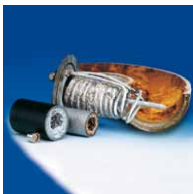
Kalkbelegg og rust
