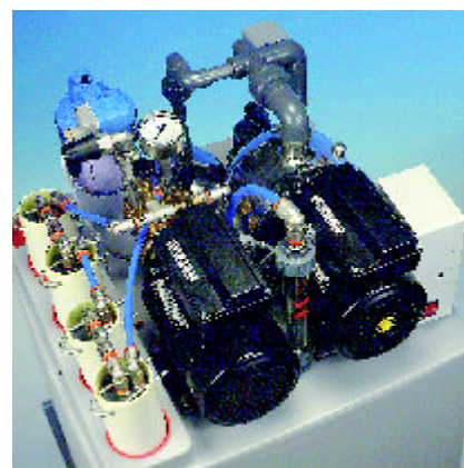
RO-270-serien med indbygget reservoir og pumpe.
